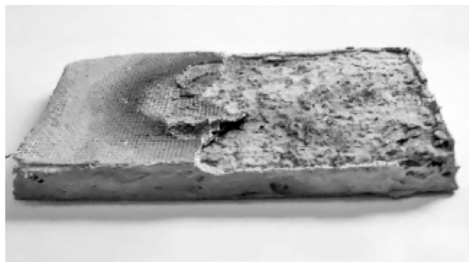
Рис. 5. Внешний вид образцов МФП на основе связующего «НЕОМИД», армированного тканью КТ-11 (наружный слой) и лентой ЛКА-1200 на металлической подложке, толщина покрытия 10,5 мм a – до испытаний, б – после испытаний при максимальных температурах
