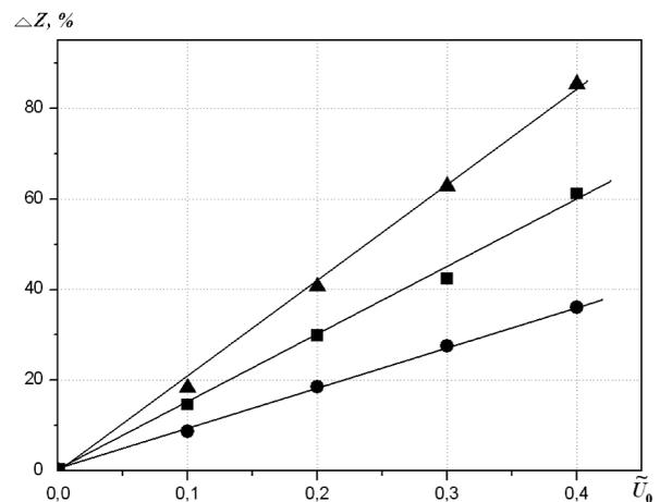
Рис. 2. Графики изменения процентного прироста среднего уровня энергии  $\tilde{E}$  (■) его стандартного отклонения  $s_E$  (●) и дисперсии  $s_E^2$  (▲) при механической обработке КМ для механической модели разрушения поверхностного слоя в зависимости от износа обрабатывающего инструмента при управляемой глубине резания
