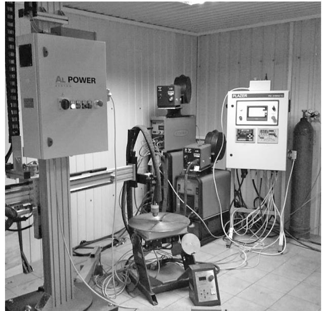
**Рис. 3.** Универсальный комплекс оборудования для плазменной сварки неплавящимся и плавящимся электродами
