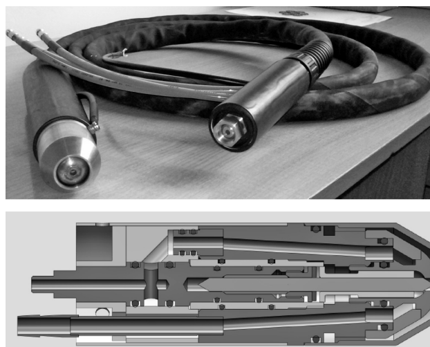
Рис. 2. Унифицированный сварочный плазматрон ПД-174М2 (ИЭС), обеспечивающий сварку в диапазоне от 80 до 350 А при ПВ 100%
