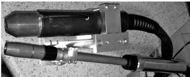
Рис. 6. Моноблок для комбинированной сварки сжатой дугой и дугой плавящегося электрода
