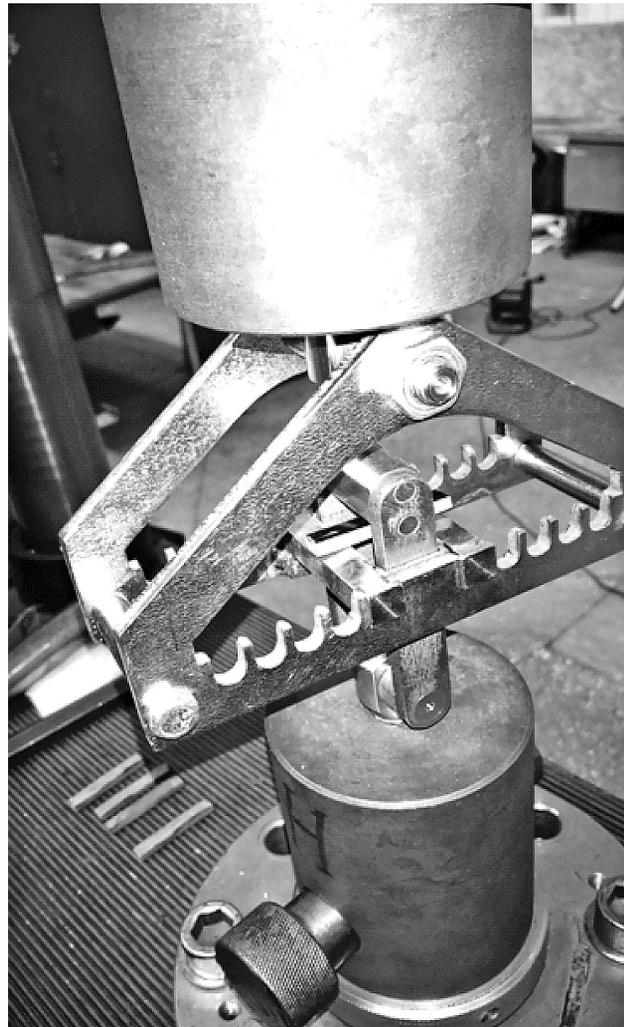
Рис. 3. Оснастка для испытания образцов на поперечный изгиб по трёхточечной схеме
