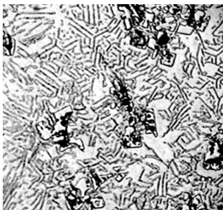
Рис. 1. Микроструктура эвтектического сплава кобальта с карбидом ниобия, X500
