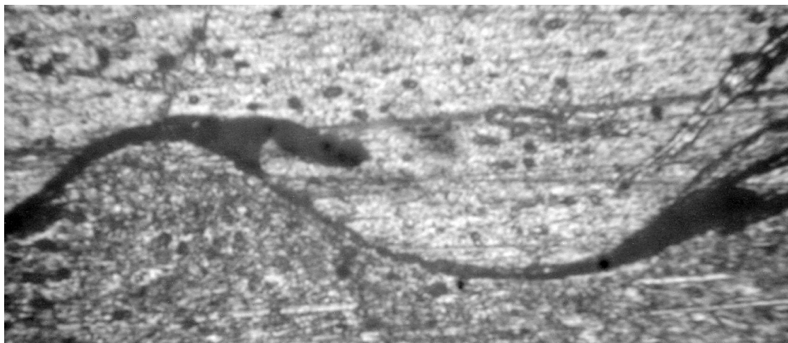
Рис. 5. Граница соединения АМг6М-А5
