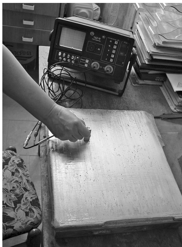
Рис. 6. Ультразвуковой контроль биметаллических заготовок
