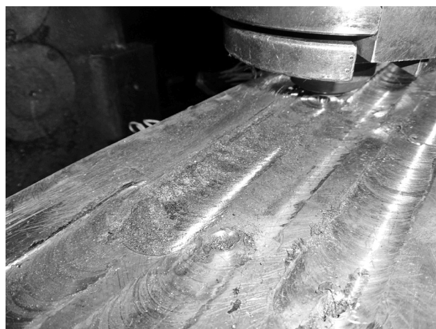
Рис. 4. Процесс СТП наплавки пластины никеля (4 мм) на медную основу
