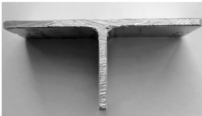
Рис. 7. Фрагмент стрингерной панели с приваренным СТП стрингером из сплава Д16Т
