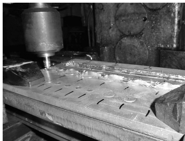
Рис. 5. Процесс заваривания СТП раковин и трещин в пластине алюминиевого сплава Д16Т
