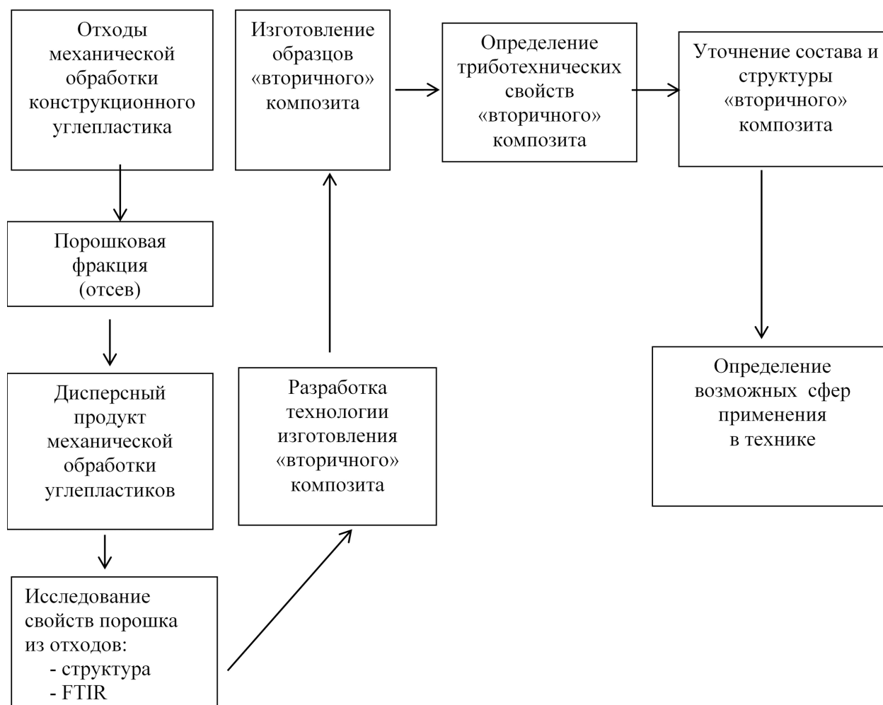
Рис. 2. Схема проведения экспериментов по получению «вторичных» углепластиков
