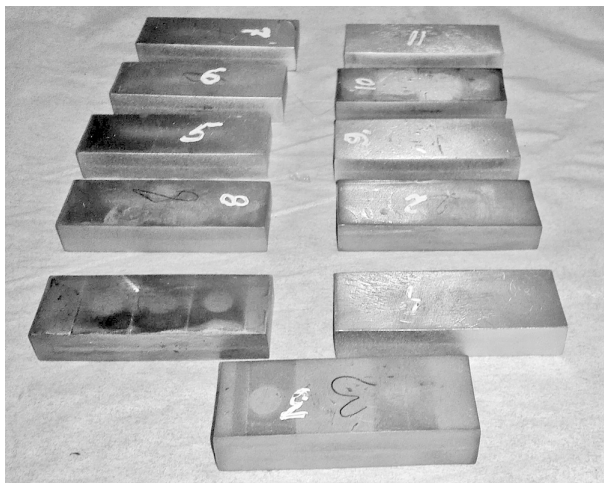
Рис. 2. Заготовки жаростойкого сплава на основе Ni-Cr
