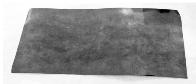
Рис. 3. Прокатанные листы фольги из жаростойкого сплава на основе Ni-Cr
