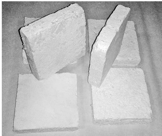
Рис. 6. Образцы плиток волокнистой керамической теплоизоляции
