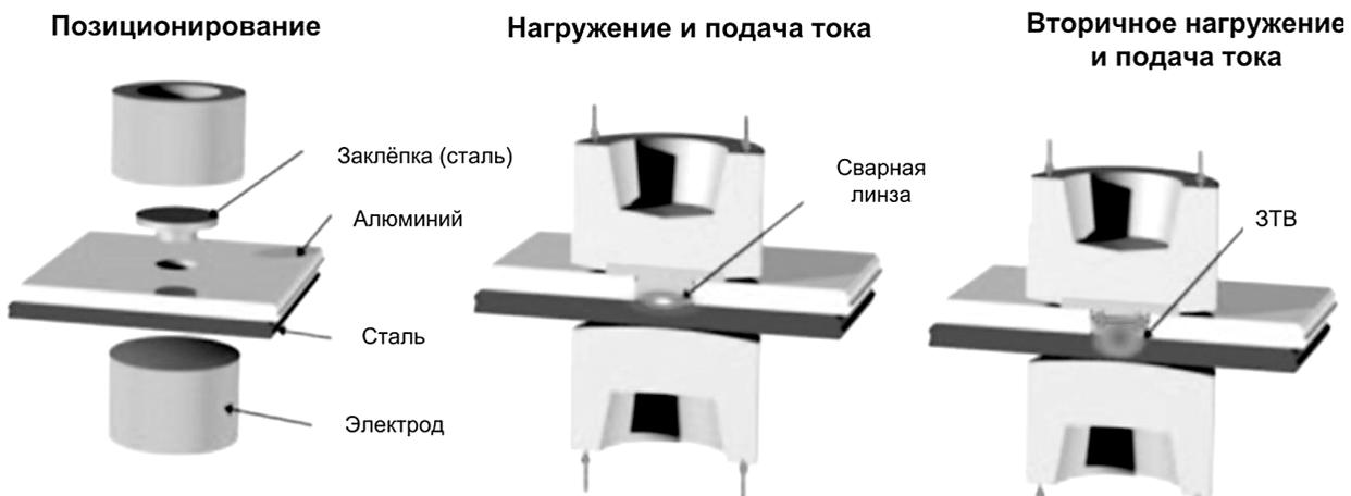
Рис. 3: Контактная точечная сварка с механическим внесением вспомогательного элемента [4]
