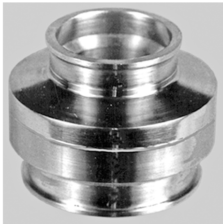
Рис. 3. Биметаллический переходный элемент нержавеющая сталь – титан для изделий РКТ
