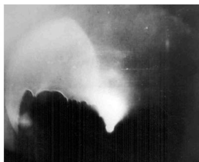
Рис. 4. Электронограмма от поверхности трения покрытия Cr-Si-B
