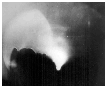
Рис. 4. Электронограмма от поверхности трения покрытия Cr-Si-B
