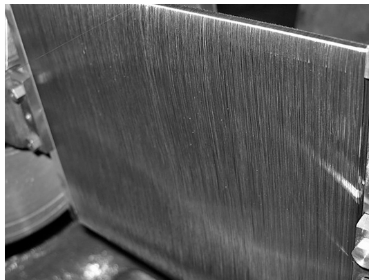
Рис. 2. Процесс наматывания проволоки на оправку
