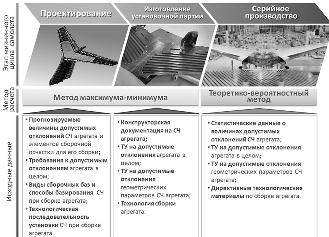
Рис. 6. Применяемые методы расчета точности геометрических параметров СбЧ
