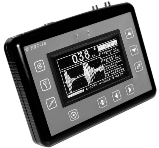
Рис. 4. Ультразвуковий товщиномір УДТ-40
