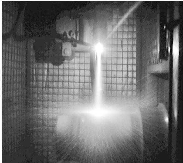
Рис. 1. Процесс создания износостойких ПДН-покрытий с помощью установки «PLAZER 30PL-W»
