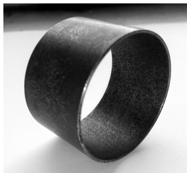
Рис. 28. Антифрикционная бронзовая втулка, пропитанная наполненным фторопластом
