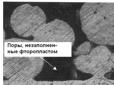
Рис. 15. Микроструктура образца МФЛ марки SF-1 толщиной 1,6 мм с порами, незаполненными фторопластом (Китай) ( \times 500 )
