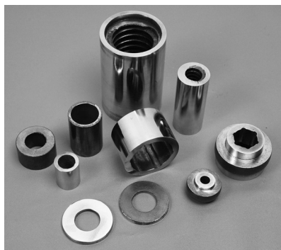
Рис. 27. Детали из спеченного самосмазывающегося материала на бронзовой основе с фторопластсодержащим антифрикционным слоем
