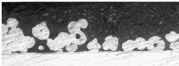
Рис. 14. Микроструктура образца МФЛ марки SF-1 толщиной 2,6 мм с неравномерным распределением бронзовых гранул (Китай) ( \times 100 )
