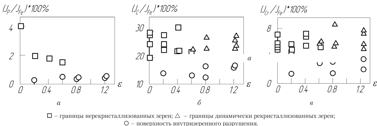
Рис. 1. Зависимость отношений интенсивностей пиков линий оже-электронов фосфора (а), углерода (б) и хрома (в) к пиков железа на поверхности изломов стали ШХ15 в зависимости от степени горячей деформации при 850 °С
