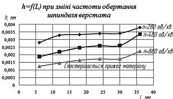
Рис. 6. Графік залежності h = f(L) при зміні частоти обертання шпинделя верстата
