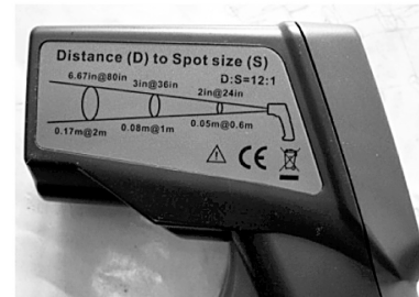
Рис. 14. Зображення лазерного пірометра, що був застосований для дослідження
