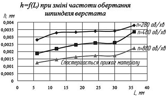
Рис. 10. Графік h = f(L) для ступінчатого свердла
