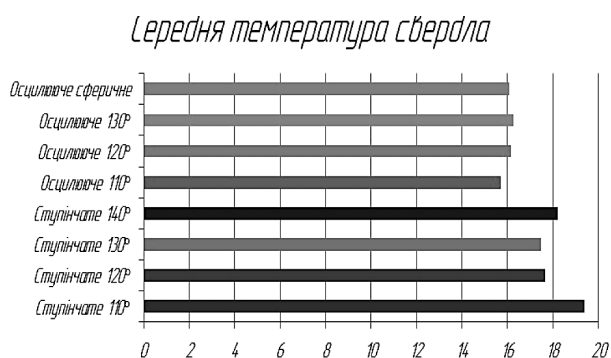
Рис. 17. Діаграма середньої температури інструменту різної конструкції
