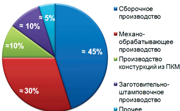
Рис. 2. Укрупненная структура трудоемкости производства самолета
