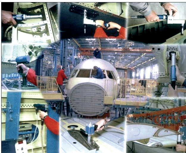
Рис. 4. Проблемно-ориентированные комплексы механизированного инструмента для агрегатно-сборочного производства
