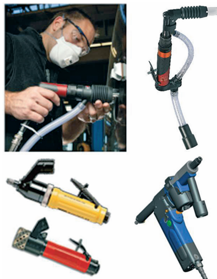
Рис. 15. Механизированный инструмент, оснащенный устройствами отсоса пыли и стружки
