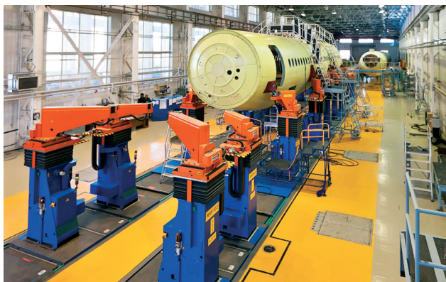
Рис. 5. Линия поточно-стендовой сборки агрегатов и планера самолета в целом
