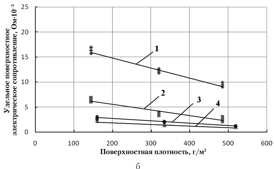
Рис. 4. Зависимость удельного поверхностного сопротивления вязаных (1,2) и вязано-паяных (3,4) сеток от поверхностной плотности: а – диаметр медной проволоки 0,08 мм; б – диаметр медной проволоки 0,12 мм; 1, 4 – вдоль петельных столбцов; 2, 3 – поперек петельных столбцов
