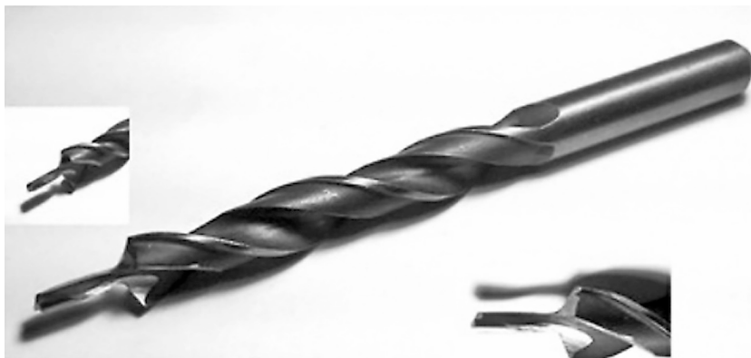
Рис. 1. Зображення двохступінчатого свердла для композиційних матеріалів, розроблене в НТУУ «КПІ»
