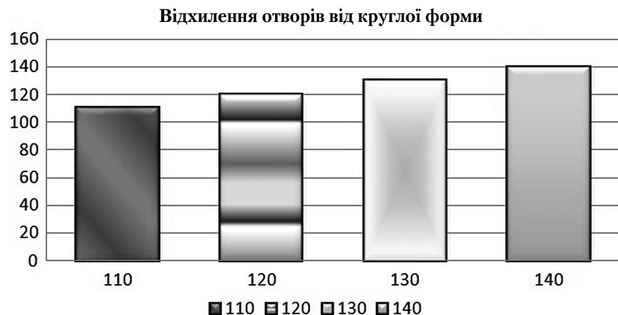
Рис. 17. Діаграма залежності середнього відхилення отворів в композиційному матеріалі від круглої форми від геометрії інструменту
