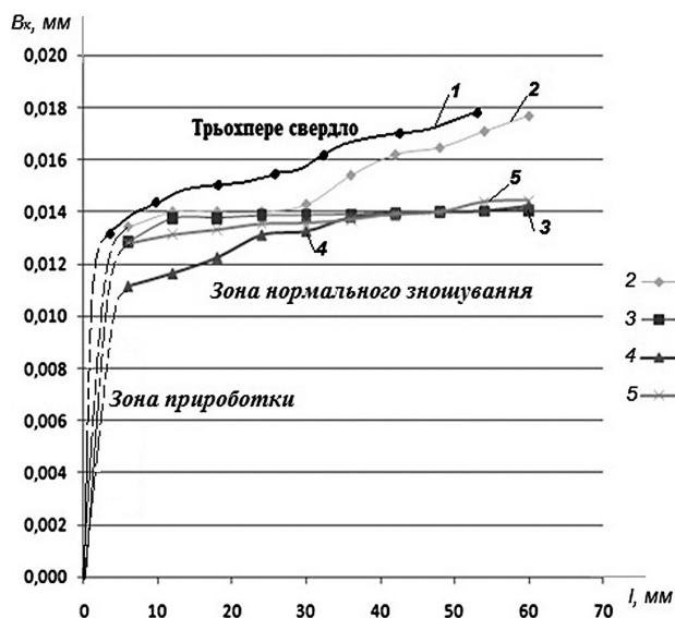
Рис. 10. Графік залежності величини зношування від шляху, пройденого свердлом: 1 – для трьохперого свердла; 2,3,4,5 – для двохступінчатих свердел з різним кутом в плані другого ступеня свердла
