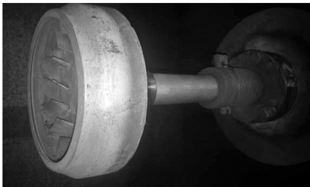
Рис. 2. Внешний вид оснастки барабанного типа для нанесения покрытий на порошки, установленной на горизонтальном валу электронно-лучевой установки
