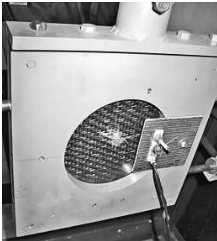
Рис. 2. Зразок досліджуваного матеріалу, закріплений на підвісі балістичного маятника
