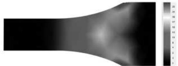
**Рис. 5.** Скорость деформации в продольном сечении заготовки в очаге деформации,  $c^{-1}$  (сплав АК6,  $\varnothing 14 \times 150$  мм, степень обжатия 50 %)
