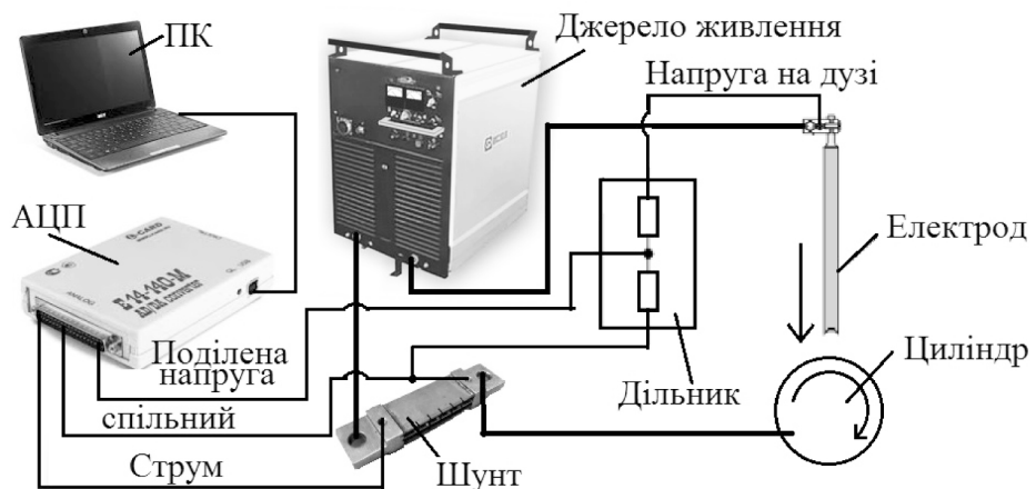
Рис. 1. Схема проведення комп'ютерного осцилографування
