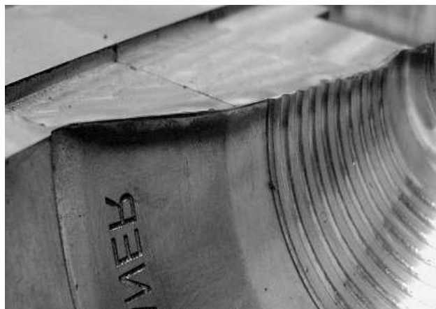
Рис. 5. Загартований шар обсічних крайок без використання захисного газу
