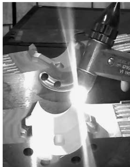
Рис. 3. Процес мікроплазмового гартування
