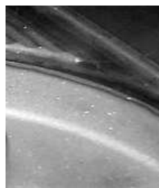
Рис. 4. Загартований шар обсічних крайок виконаний на оптимальних режимах
