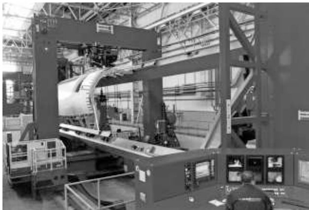
Рис. 34. Клепальный комплекс (КНАПО)
