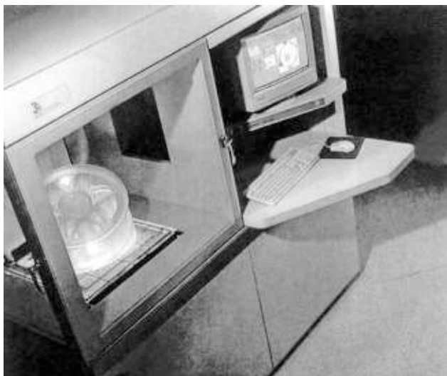
Рис. 18. Установка лазерной стереолитографии (серия SLA-5000)
