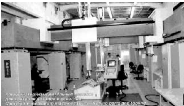
Рис. 14. Координатно-измерительный комплекс на базе КИМ ТСХ-8000 фирмы POLI (Италия)
