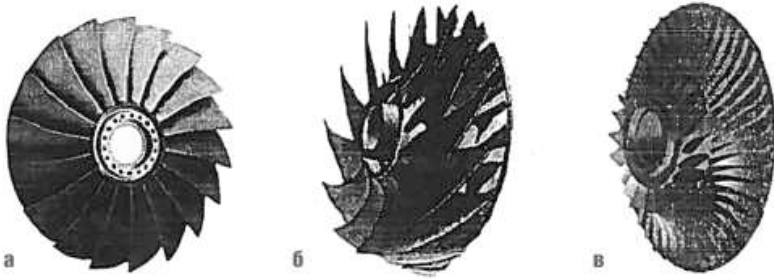
Рис. 37. Ступени вентилятора и компрессоров: а — ступень вентилятора типа «блиск»; б — сплиттерная ступень; в — центробежная ступень на \pi_k^* = 3,15
