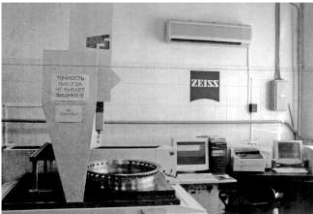
Рис. 15. КИМ Zeiss в производстве ГТД Пермского моторостроительного комплекса
