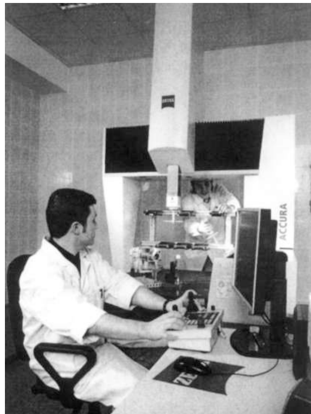
Рис. 16. Координатно-измерительная машина Zeiss Accura 7 (МПО им. И. Румянцева)
