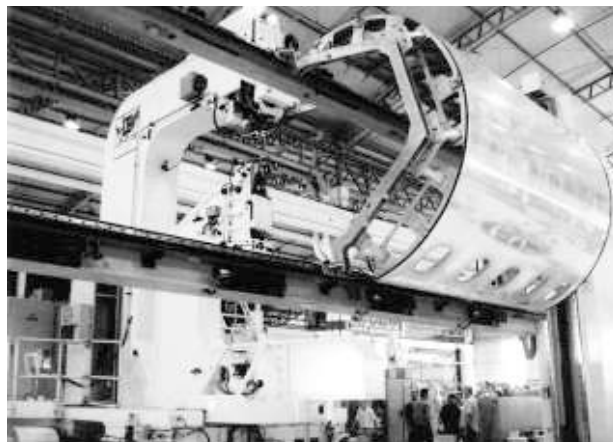
Рис. 35. Уникальный клепальный автомат «GEMCOR» (Ульяновский авиационный завод «Авиастар-СП»)
