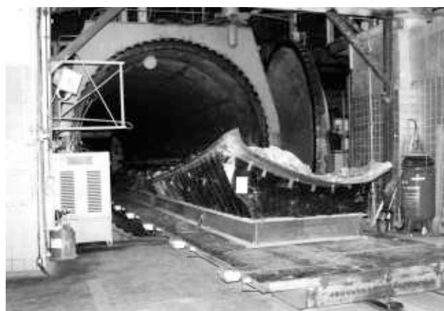
Рис. 26. Автоклав для производства интегральных конструкций из ПКМ широкофюзеляжного транспортного самолета Ан-124
