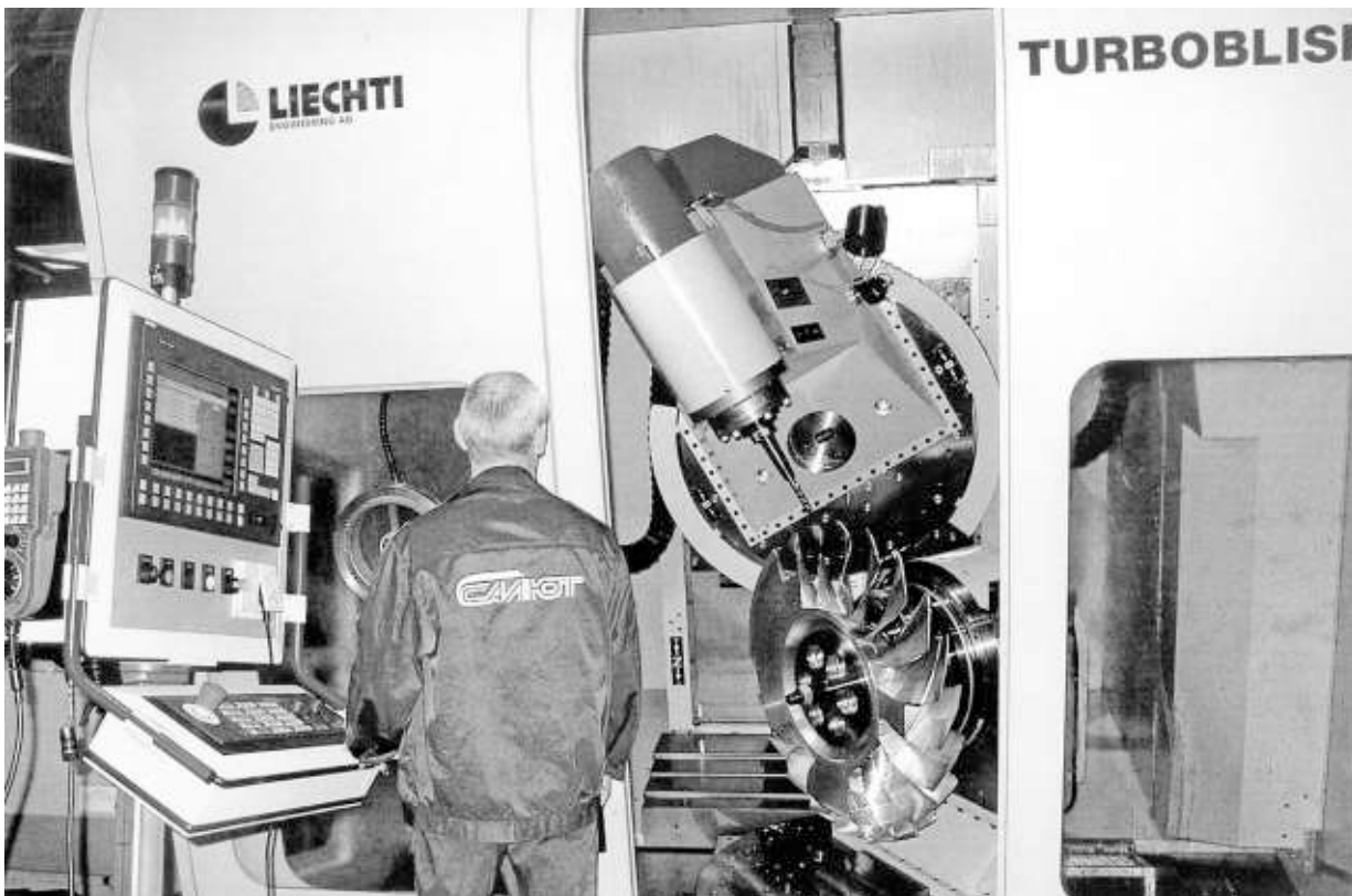
Рис. 38. Обрабатывающий центр — уникальный для выполнения технологии TURBOBLISK (ФГУП ММП «Салют»)
