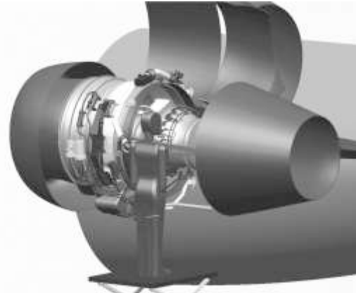
Рис. 9. Использование электронного макета при оценке возможности технического обслуживания
