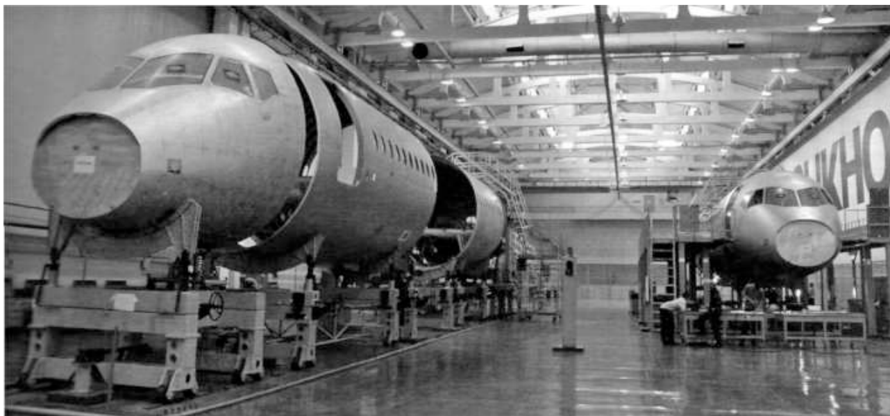
Рис. 2. В цехе сборки фюзеляжей Sukhoi Superjet-100
