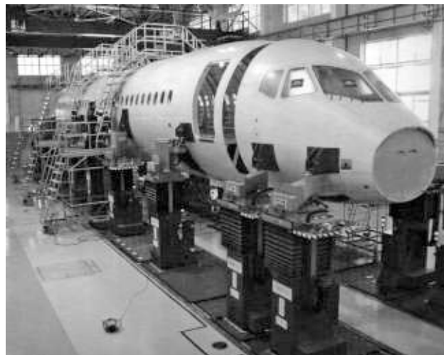
Рис. 7. Стенд стыковки фюзеляжа регионального самолета — новое слово в авиастроительной отрасли
