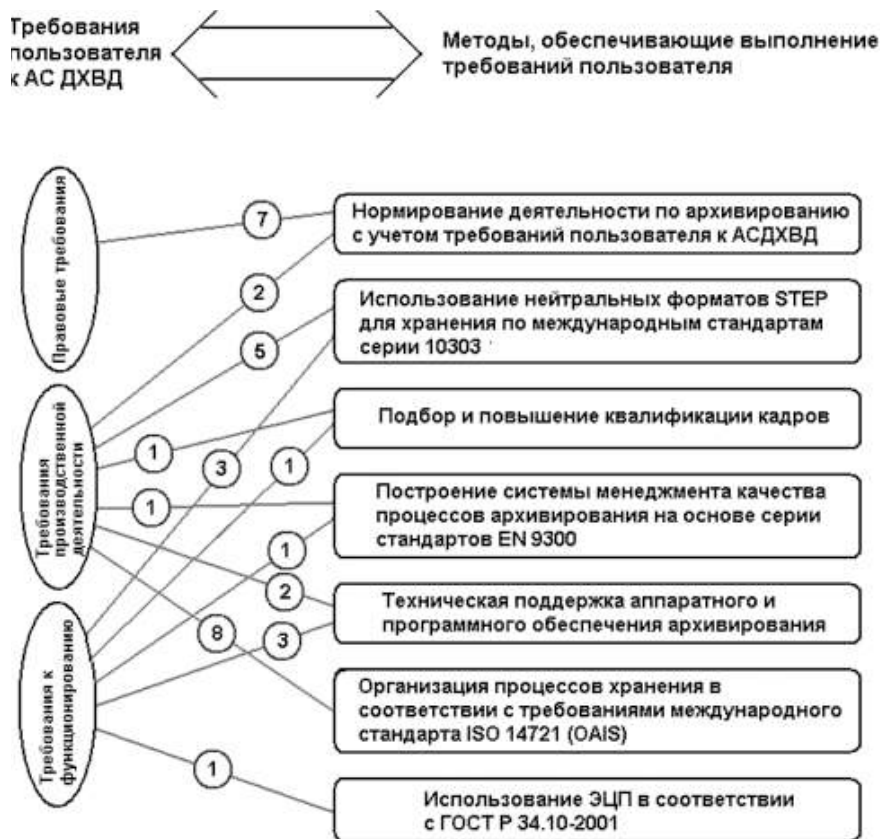
Рис. 3. Взаимосвязи требований пользователя к системе ДХВД и методов обеспечения их выполнения
