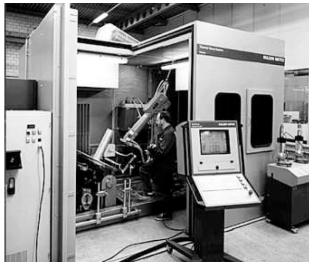
Рис. 11. Установка для плазменного напыления фирмы Sulzer metco
