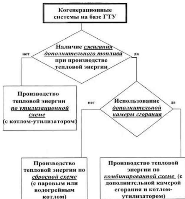
Рис. 3. Классификационная схема когенерационных технологий на базе газотурбинных установок
