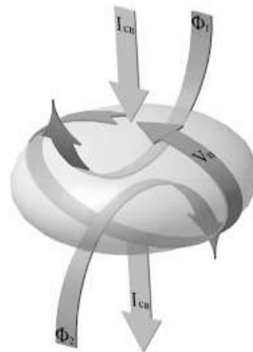
Рис. 1. Схема создания электромагнитных воздействий при точечной контактной сварке
