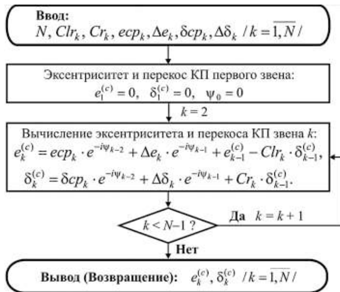
Рис. 8. Развернутая блок-схема алгоритма виртуальной сборки ротора на ПСС
