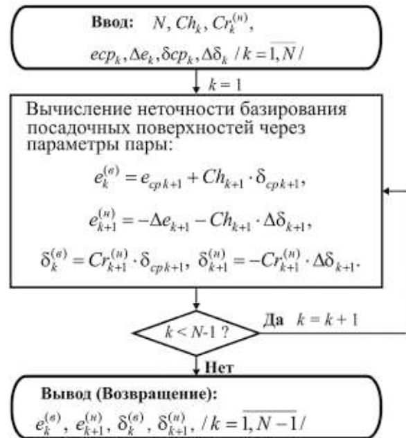
Рис. 4. Развернутая блок-схема алгоритма вычисления неточности базирования посадочных поверхностей
