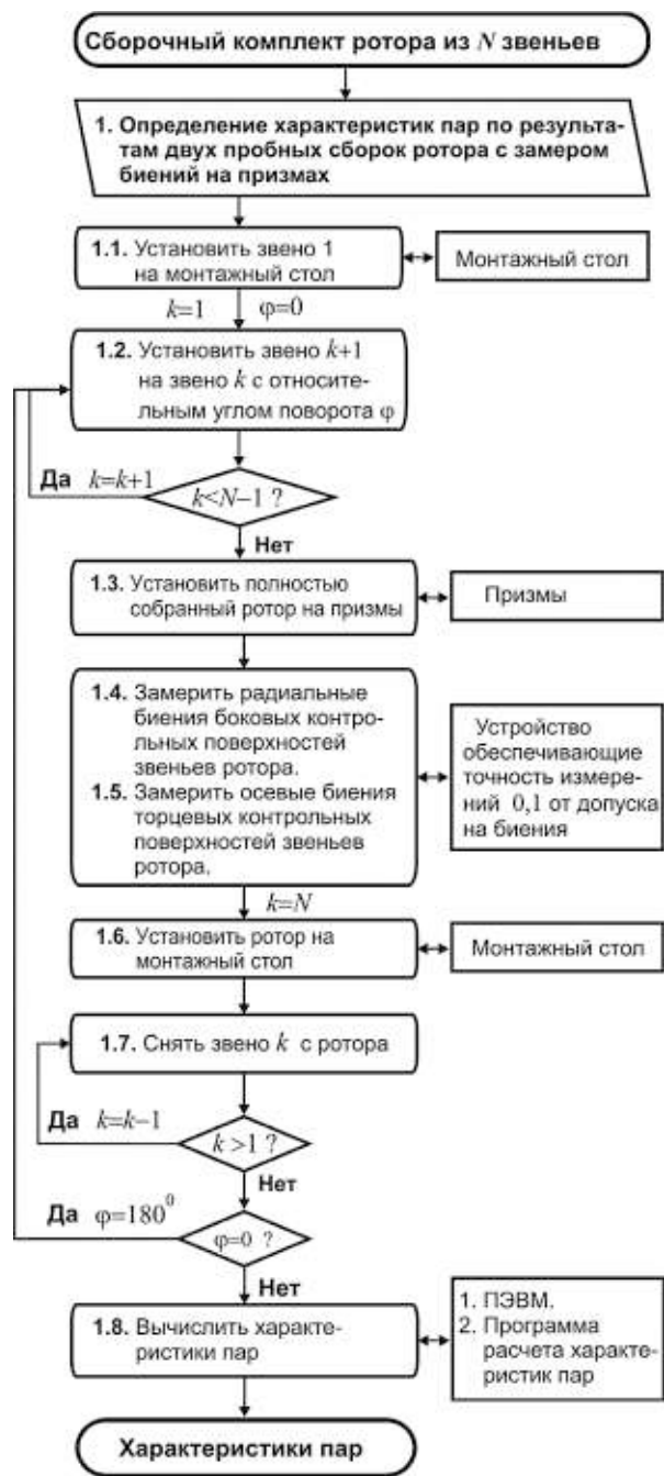
Рис.2. Развернутая блок-схема типового техпроцесса определения характеристик пар
