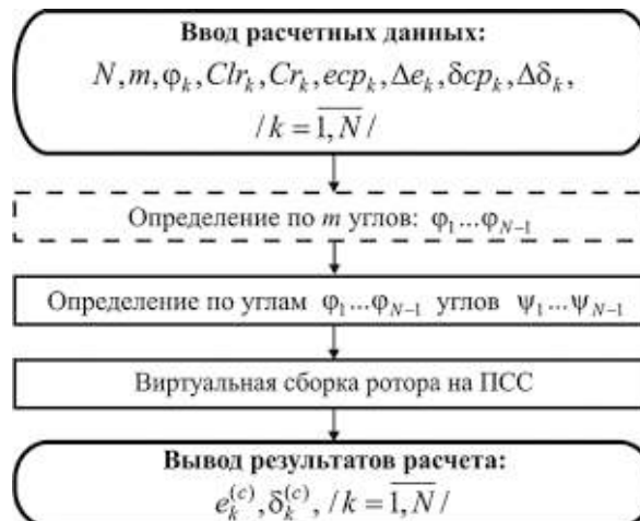
Рис. 5. Укрупненная блок-схема алгоритма разовой виртуальной сборки ротора с замером биений на ПСС
