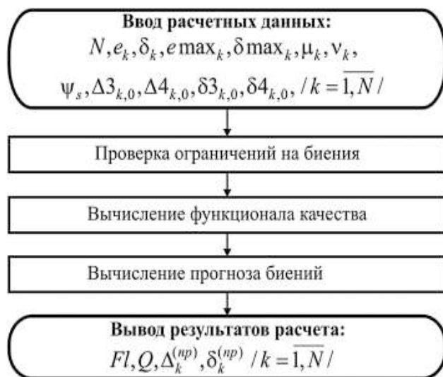
Рис. 15. Укрупненная блок-схема информационного алгоритма
