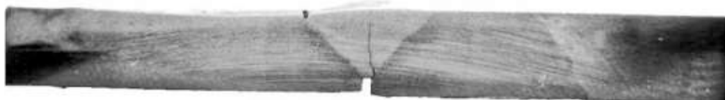
Рис.1. Макрошліф зварного з'єднання труби \varnothing 89 \times 6 із сталі 20 з непроваром в корені шва завглибшки 1,2 мм з тріщиною, що розповсюджується до зовнішньої поверхні труби
