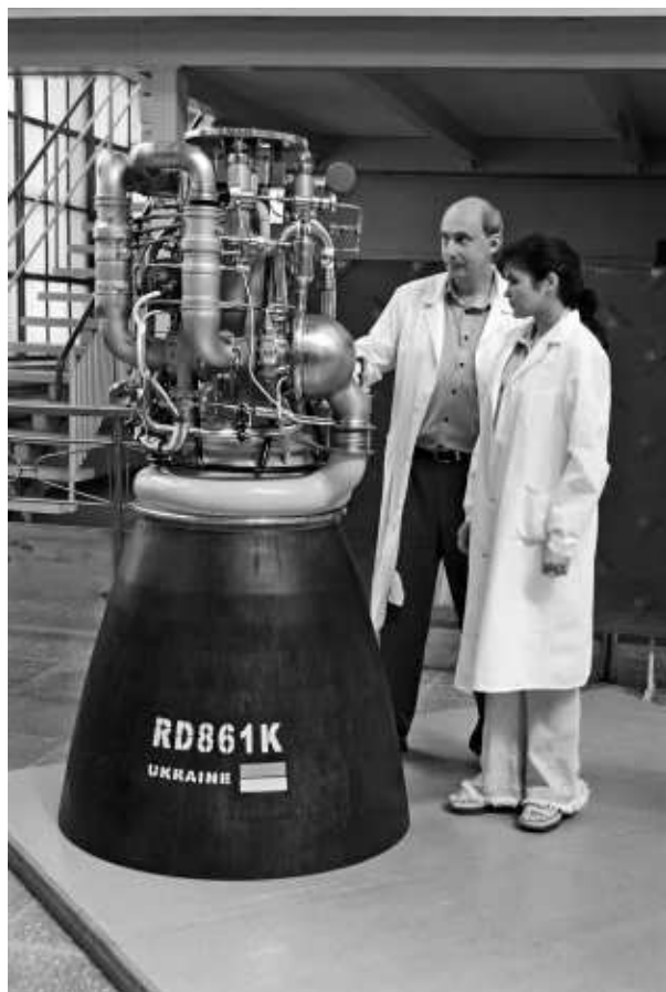
Рис. 3. ЖРД с насадком из УУКМ
