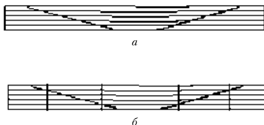
Рис. 5. Види ремонту шляхом постановки приформованих латок (а) та з пришиванням їх країв (б)
