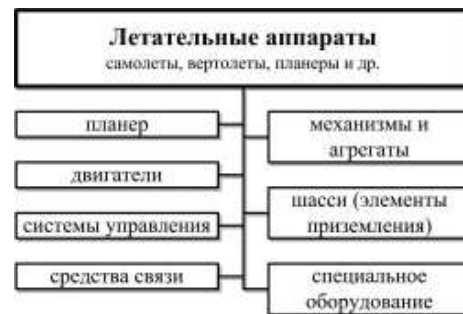
Рис. 5. Структурная схема элементов изделий авиастроения
