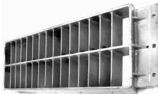
Рис. 2. Внешний вид экспериментальной решётки из входящих, отлитых из реактопласта под давлением
