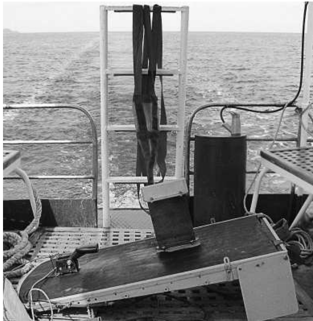
Рис. 2. Общий вид буксируемой системы «Кливер-ЭЛ» и ее выборка на борт судна
