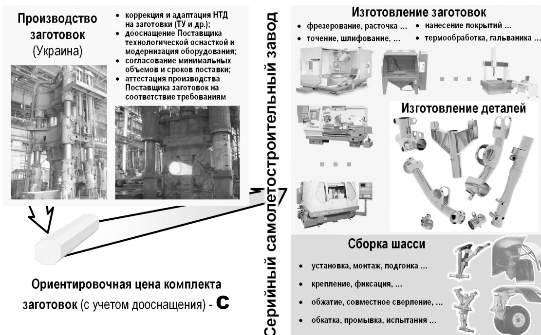
Рис. 4. Альтернативная схема комплектации шасси украинского гражданского воздушного судна. Вариант I. Отечественный поставщик заготовок
