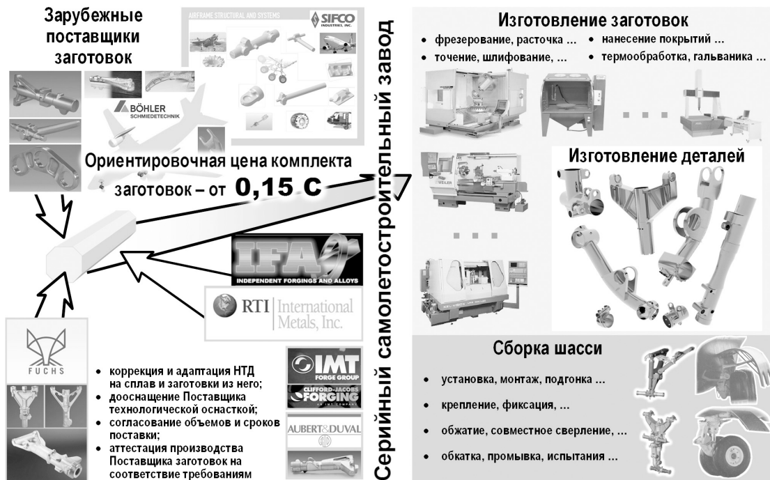
Рис. 5. Альтернативная схема комплектации шасси украинского гражданского воздушного судна. Вариант II. Зарубежные поставщики заготовок
