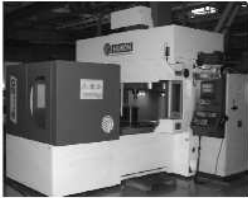
Рис. 8. Высокоскоростной 3-х координатный фрезерный центр K2X20
