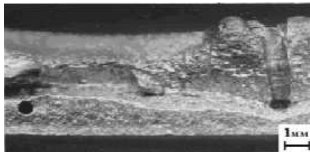
Рис. 4. Излом шва с образованием поры из засверленного отверстия
