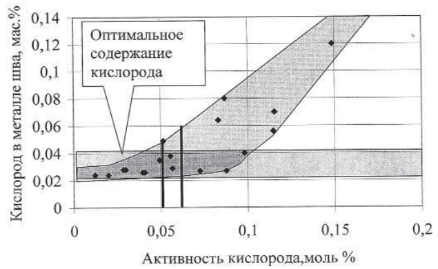
Рис. 1. Зависимость содержания кислорода в металле шва от уровня термодинамической активности кислорода в шлаковом расплаве
