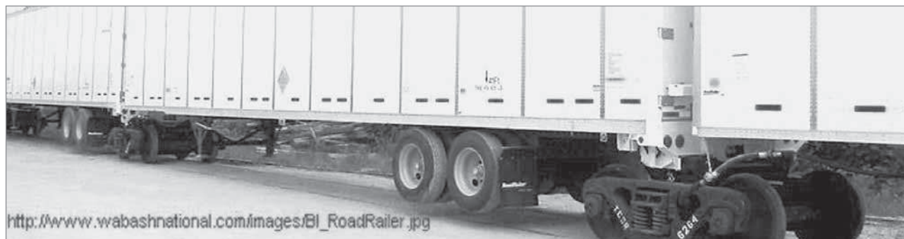
Рис. 1. Подвижной состав бимодальной системы «RoadRailer»
