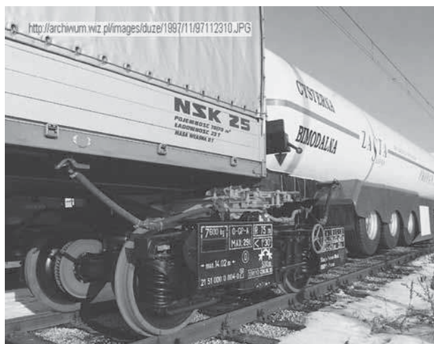
Рис. 3. Состав бимодальной системы «ТАВОР»
