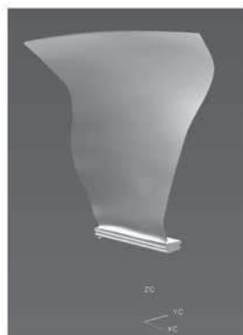
Рис. 1. Модель широкохордной вентиляторной лопатки
