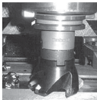
Рис. 10. Крепление катушечной фрезы в инструментальном модуле HSK-63A
