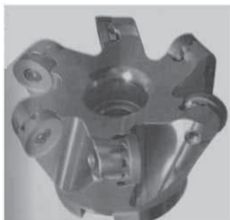
Рис. 13. Катушечная фреза фирмы SKIF MT200-100B32R07RP16
