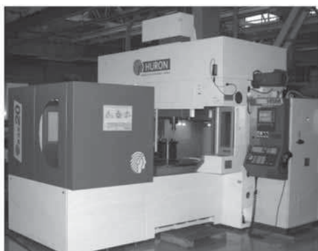
Рис. 8. Высокоскоростной 3-х координатный фрезерный центр K2X20
