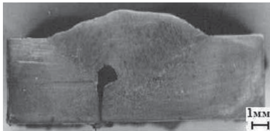
Рис. 6. Макрошлиф шва с зародышем поры, полость которого соединяется с атмосферой
