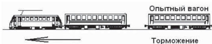
Рис. 3. Проведение тормозных испытаний методом "бросания"
