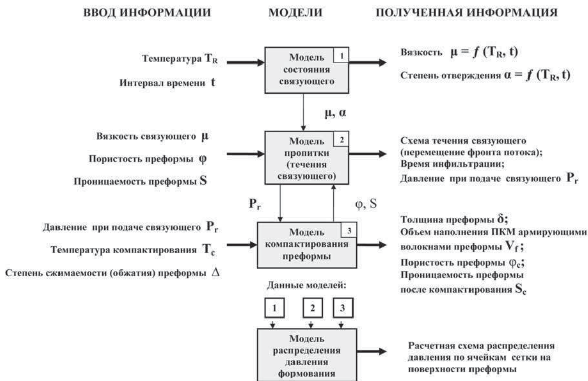
Рис. 6. Схема моделирования пропитки связующим преформы под давлением
